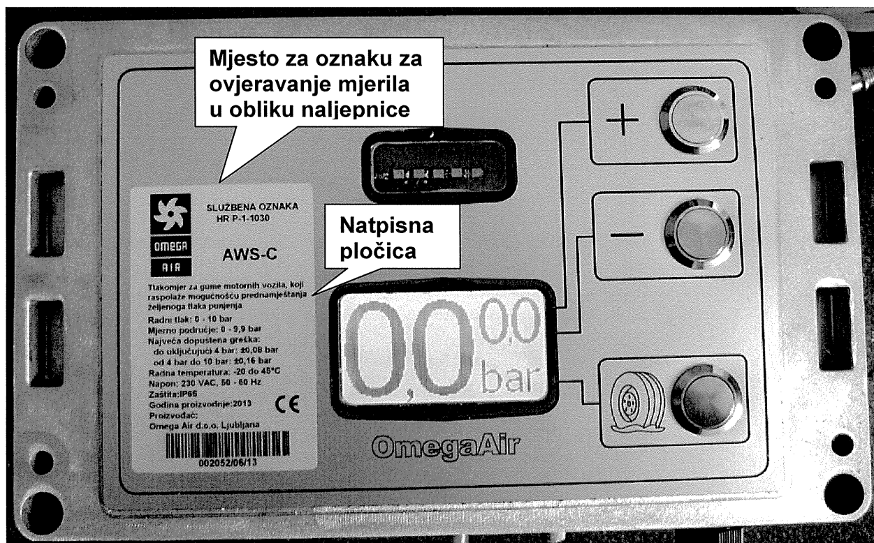
Slika 1: Tlakomjer za gume motornih vozila tip AWS-C - Smještaj natpisne pločice i mjesto za oznaku za ovjeravanje mjerila u obliku naljepnice
